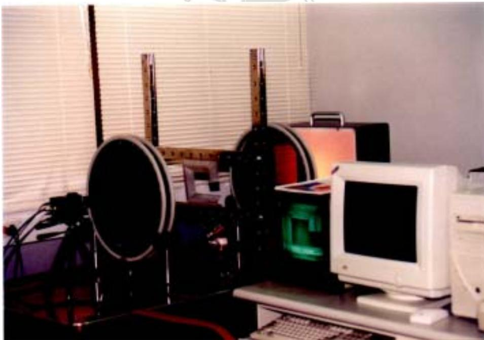
圖 2-6 數位式光彈量測系統
