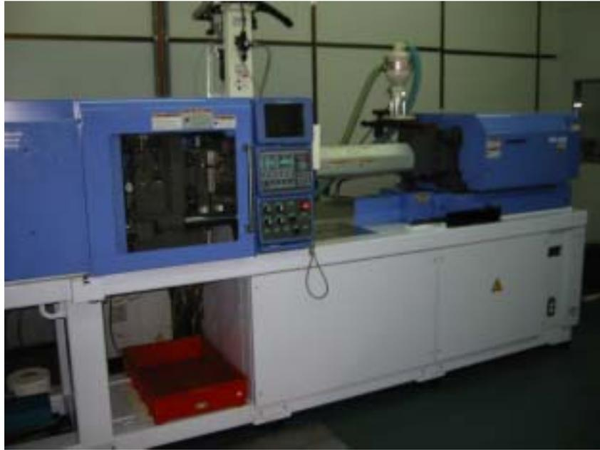
圖 2-1 日鋼 JSW J85EL 全電式射出成型機
