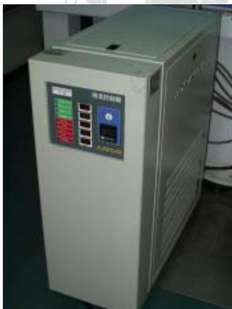
圖 2-4 油路循環模溫控制機
